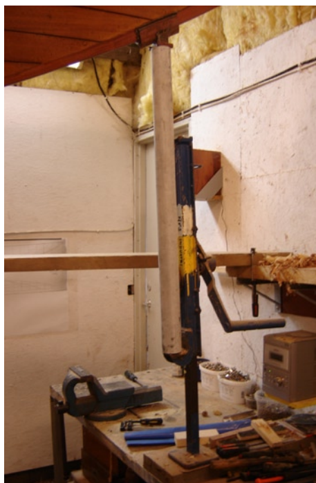
Så här höjer man stäven på en gammal båt som krökt rygg. Fem millimeter per månad hissades domkraften sedan skrovet först gjorts följsamt.
