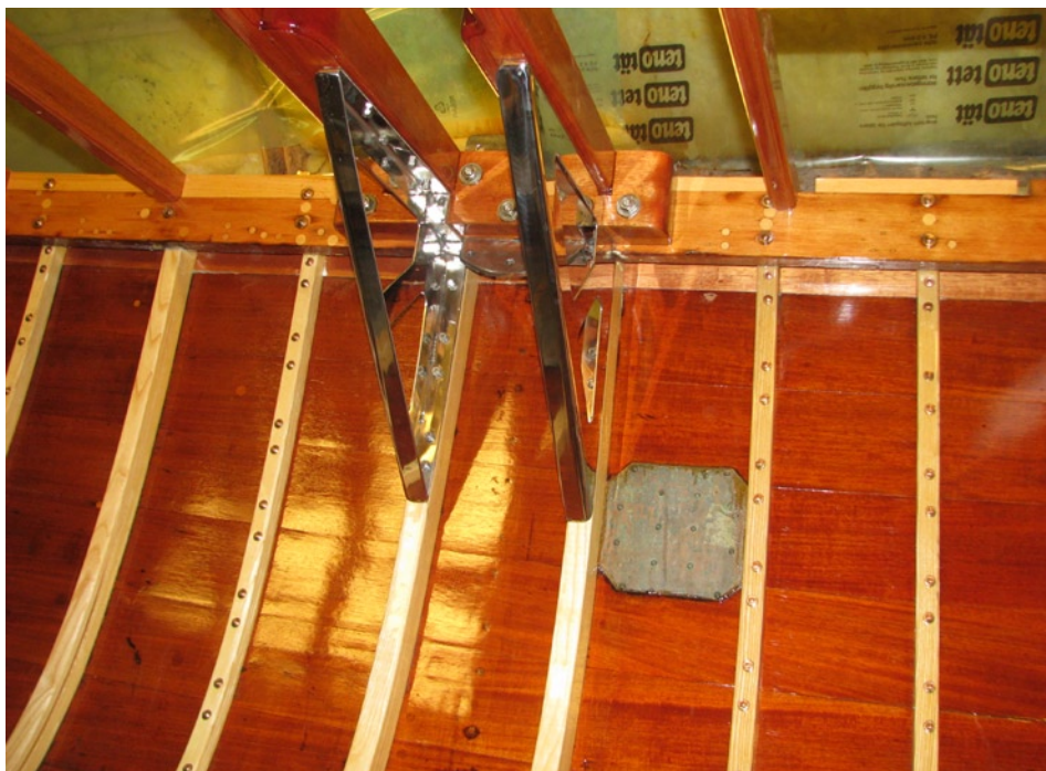
Vid mastgenomföringen förstärks däcksbalkarna av knän i rostfritt, dragkrafterna från vanten ska även ledas ned via ställänkar till mastfoten.
